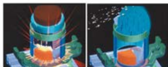
Dans le cœur, les crayons de combustible se fragmentent. Les pastilles d'oxyde d'uranium, surséchouffées, explosent.
